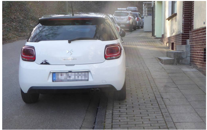
Bild 50: Abgesenkte Bordsteine und eine kleinteilige Pflasterung laden zum Falschparken ein.
